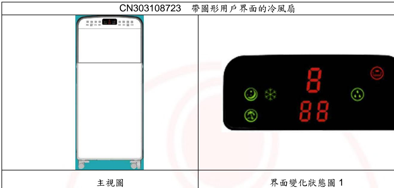
這類專利中，其圖形用戶界面是以類似電子錶的液晶螢幕所呈現，例如 CASIO 的電子錶或計算機的數字式液晶螢幕所呈現的數字。此種液晶螢幕已經預先設置既定的數字／符號圖形，並且配合內建的控制器來控制顯示一部分或所有的既定數字／符號圖形。然而，此種液晶螢幕中的最小圖形基本單元並非陣列排列的像素，無法透過控制特不同的像素來呈現各種圖形。
