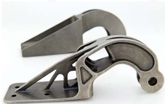
圖 4、空中巴士的 3D 列印鉸鍊（前）與傳統鉸鍊（後） （圖片出處：blog.sculpteo.com 網站）
